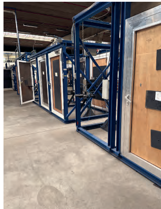
Prüfungen zu Funktion, Belastbarkeit und Dauerhaftigkeit gehören bei Sobinco zum Entwicklungsprozess. Eigene Testeinrichtungen unterstützen die kontinuierliche Optimierung der Beschlagsysteme. Foto: bauelemente bau
